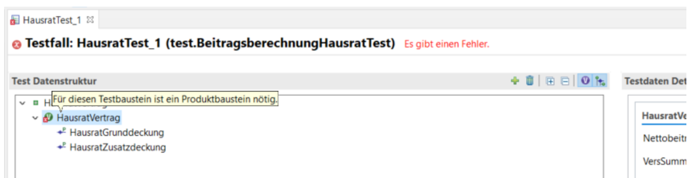
Figure 110. Testfalleditor mit Hinweis auf fehlenden Produktbaustein
